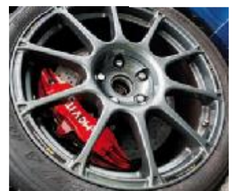
Die ATS-GTR-Räder messen 9,5 x 18 Zoll und wiegen nur je 9,5 Kilogramm
